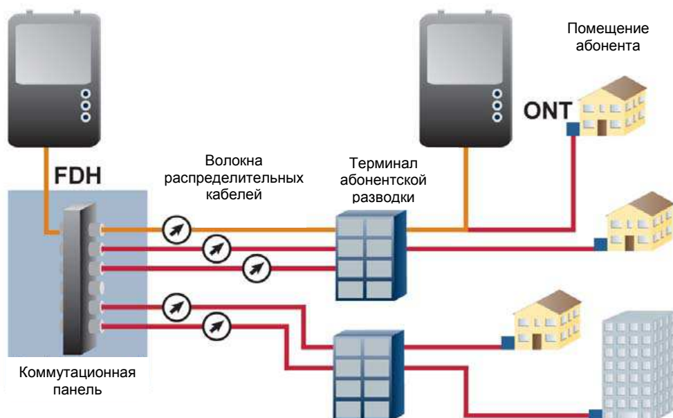
Рисунок 106: Измерение вносимых потерь (IL) и затухания обратного отражения (ORL) с использованием двух тестеров
