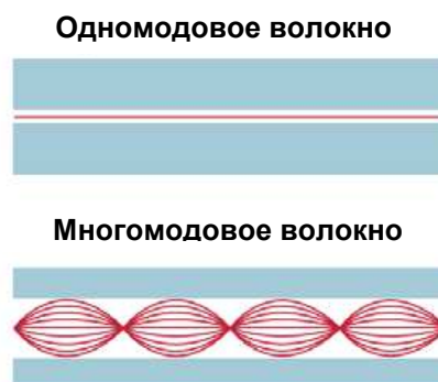
Рисунок 87: Распространение светового луча в волокне
