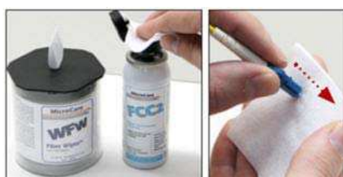
Рисунок 103: Пример влажной очистки коннекторов с помощью безворсовой салфетки и очищающей жидкости
