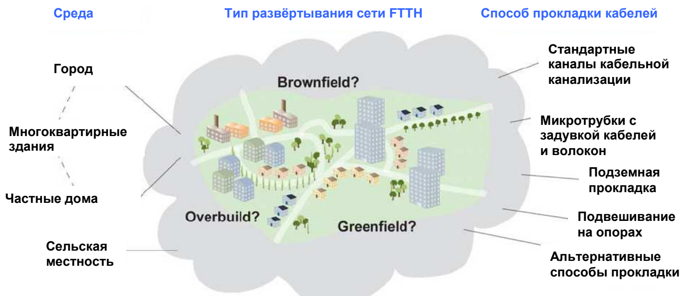
Рисунок 1: Тип развёртывания сети FTTH
