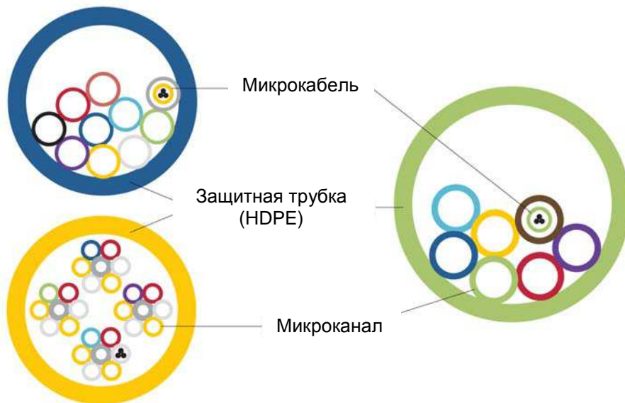
Рисунок 67: Защитные микроканалы со свободным размещением
