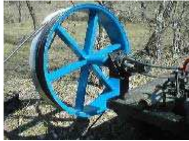
Рисунок 55: Барабан кабельной лебёдки
