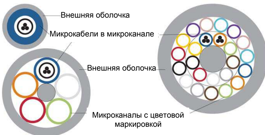
Рисунок 69: Защитные каналы с интегрированными микроканалами
