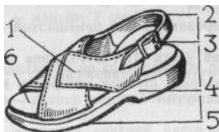
Рис. 191. Мужская сандалета: 1 — ремни союзки; 2 — ремни задней части; 3 — застежка; 4 — каблук; 5 — подошва; 6 — носочная часть
